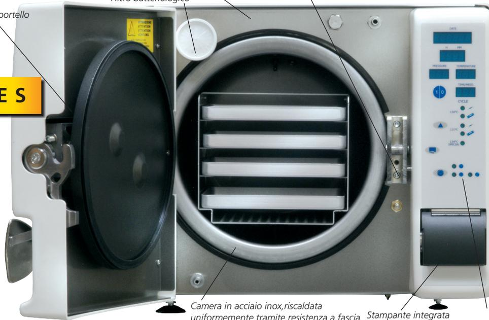
Camera in acciaio inox, riscaldata uniformemente tramite resistenza a fascia
